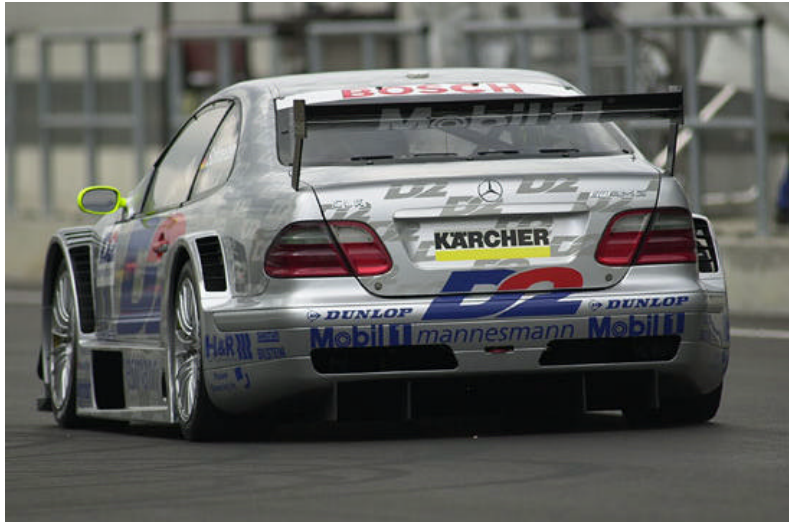
Fig. 26: Bakvingen relativt högt placerad trots att en diffusor används.
