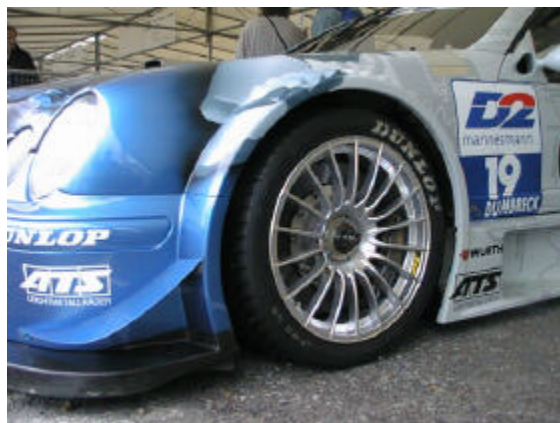
Fig. 18: Dive-plates ger ett lite extra downforce och används för att förbättra balansen i bilen.
