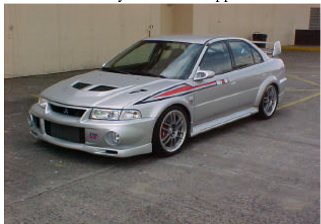
Fig. 21: Mitsubishi släpper ut kylflödet genom huven
